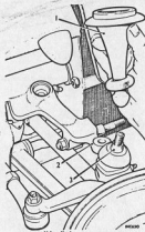
Abb. K.4 Ausbau der Federtrabe (1); Feder zusammenge- drückt und oberer Lenker (2) vom Hakenkugel- bolzen (3) abgenommen
